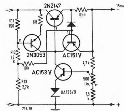
Fig. 8 - Interruzione elettronica.
