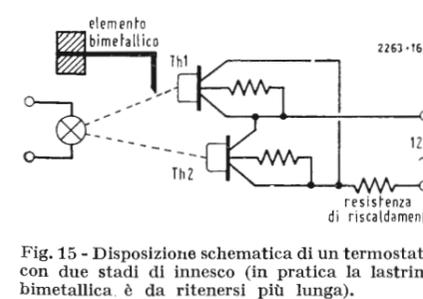
Fig. 15 - Disposizione schematica di un termostato con due stadi di innesco (in pratica la lamina bimetallica è da ritenersi più lunga).
