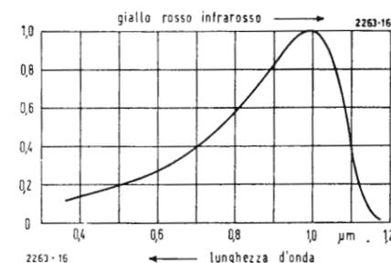
Fig. 4 - Sensibilità spettrale del fototiristore.
