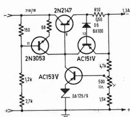
Fig. 7 - Limitazione elettronica di corrente.
