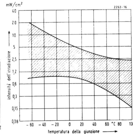
Fig. 5 - Caratteristica luce-temperatura per il tipo L9. La zona tratteggiata rappresenta il campo di tolleranza, che interessa al variare della temperatura.
