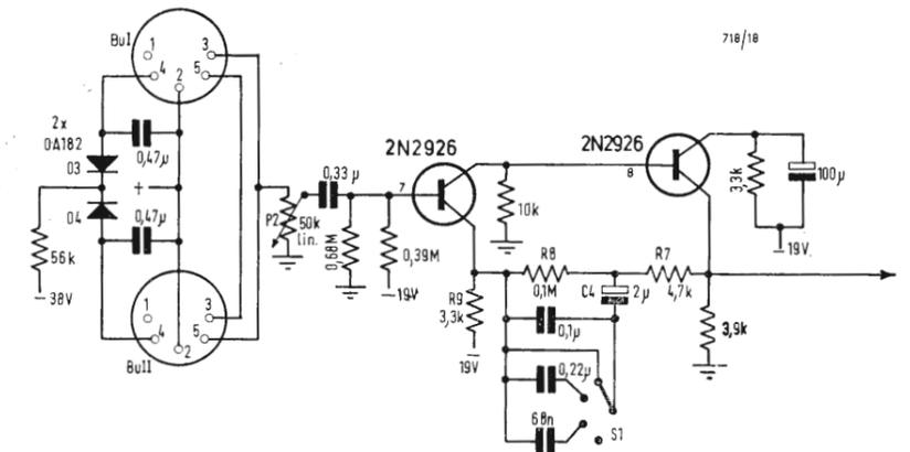
Fig. 5 - Stadio preamplificatore con correzione.
