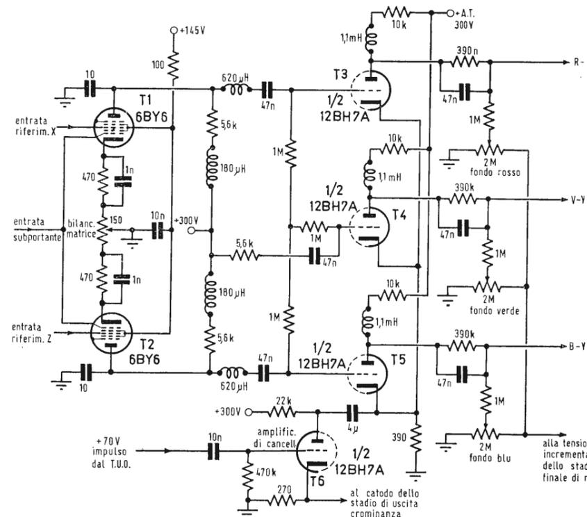
Fig. 5 - Rivelazione XZ e circuito matrice per il sistema americano a 525 righe
