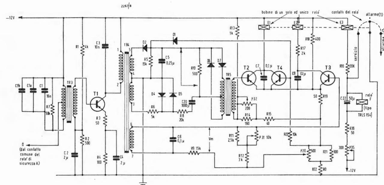
Fig. 5 - Circuito elettrico completo del dispositivo differenziale. Il relé  $E$  possiede tre avvolgimenti distinti e separati  $E_1$ ,  $E_2$  ed  $E_3$ ; gli effetti delle varie eccitazioni si sommano algebricamente ed agiscono su un contatto a tre posizioni: « servizio », « allarme I » ed « allarme II ». In posizione « allarme I », l'eccitazione del relé  $F$  è interrotta, il che pone in azione le temporizzazioni e gli allarmi.
