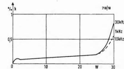
Fig. 10 - Fattore di distorsione in funzione della potenza di uscita e della frequenza (a 4  $\Omega$ ).
