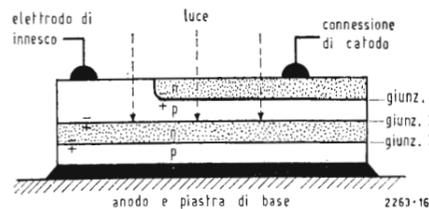
Fig. 2 - Struttura a quattro stadi del fototiristore.
