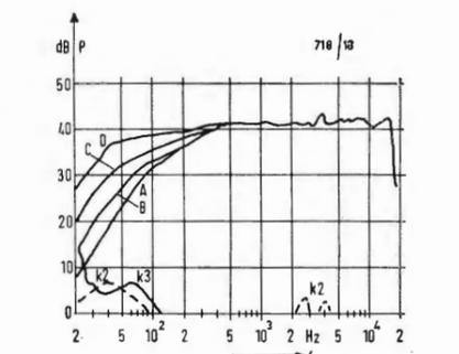
Fig. 13 - Risposta in frequenza della combinazione amplificatore-altoparlante.
