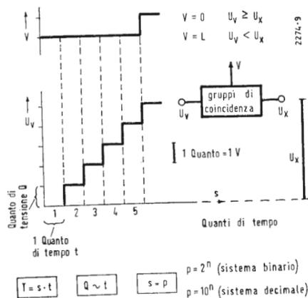
Fig. 5 - Costruzione delle grandezze di confronto:  $Q$  = quanto di tensione;  $t$  = quanto di tempo, durata di un passo;  $s$  = numero dei passi;  $p$  = numero dei quanti di tensione;  $T$  = tempo necessario per la conversione, tempo di misura. Nel sistema decimale si ha la relazione  $p = 10^m$ ; nel sistema binario  $p = 2^n$ .
