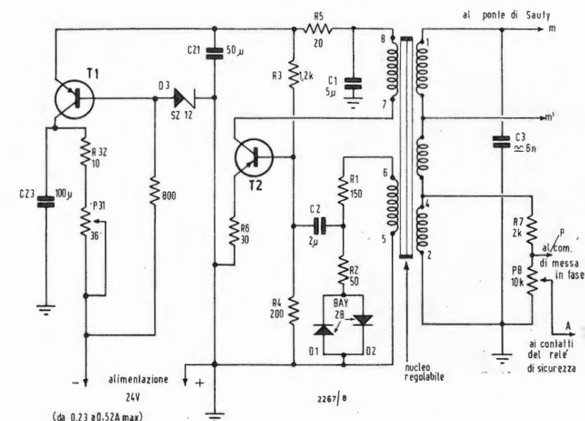
Fig. 3 - Schema elettrico del circuito di alimentazione e del generatore a 20 kHz. Il secondario del trasformatore TR, di uscita, del tipo a nucleo regolabile, costituisce insieme con il condensatore C<sub>3</sub> un circuito accordato sulla frequenza precedentemente citata. I diodi D<sub>1</sub> e D<sub>2</sub> svolgono la funzione di mantenere costante la tensione fornita da questo generatore.
