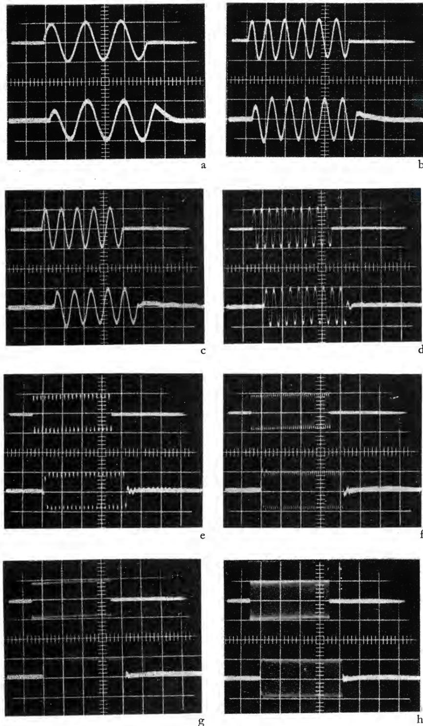
Fig. 14 - Comportamento alla sovralongazione, misurata acusticamente a diverse frequenze. a) a 60 Hz; b) a 125 Hz; c) a 250 Hz; d) a 500 Hz; e) a 1 kHz; f) a 2 kHz; g) a 4 kHz; h) a 8 kHz.
