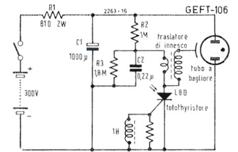
Fig. 14 - Apparecchio di fotolampo a comando luminoso.
