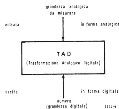
Fig. 1 - Schema di principio di un convertitore analogico - digitale.
