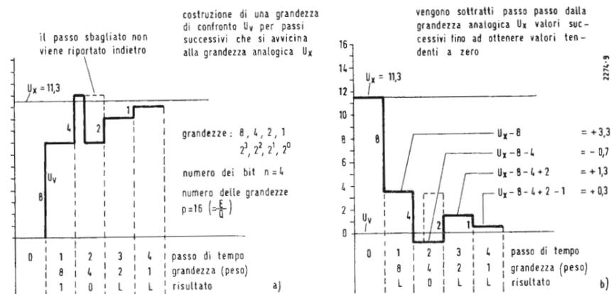
Fig. 9 - Metodo ponderato: a) costruzione della tensione di confronto; b) costruzione della tensione di coincidenza per sottrazione.
