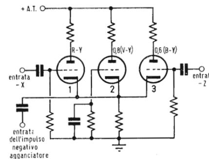
Fig. 3 - Circuito fondamentale della matrice XZ
