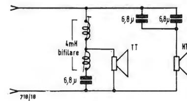
Fig. 15 - Schema della connessione degli altoparlanti.
