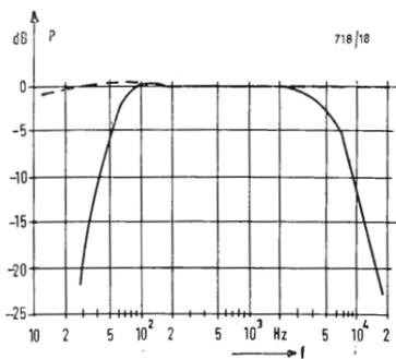
Fig. 18 - Effetto della funzione dei tasti: filtro antirimbombi e filtro antifruscio.
