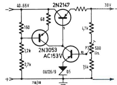
Fig. 6 - Stabilizzazione elettronica di tensione.
