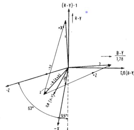
Fig. 4 - Diagramma vettoriale del circuito della matrice XZ
