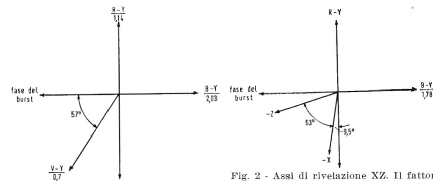
Fig. 1 - Posizione dell'asse di rivelazione V—Y
