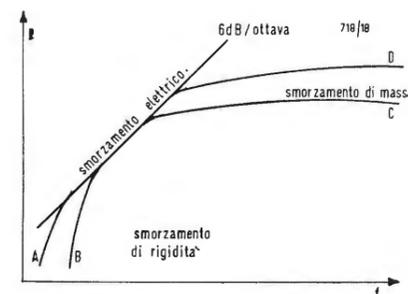
Fig. 1 - Curve di frequenza fondamentali del livello sonoro P di altoparlanti.
