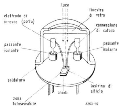
Fig. 1 - Costituzione di un fototiristore (General Electric).
